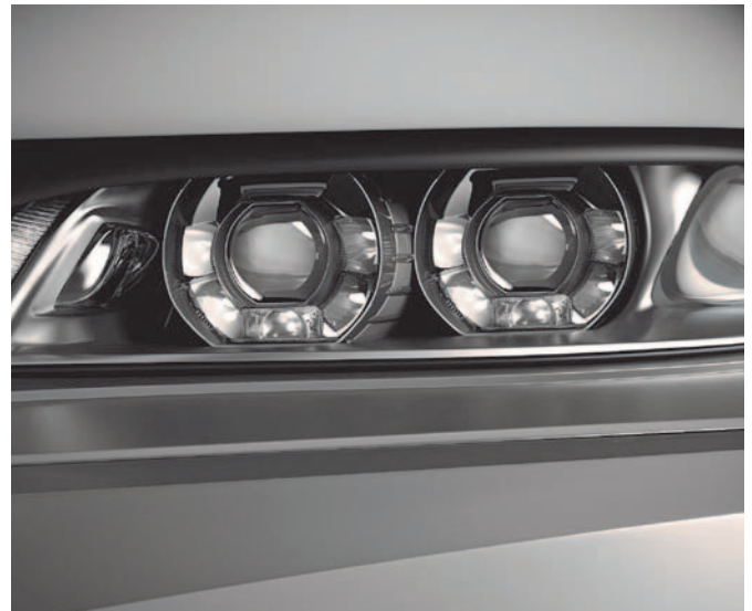
Docter Optics ist internationaler Marktführer in der Serienherstellung von Asphären und Freiformlinsen für Automobil-Projektionsscheinwerfer (Halogen, Xenon, LED und Laser).
